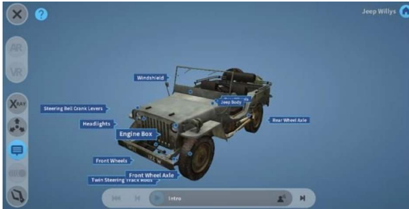
Imagen 2: Lección Jeep Willys para aprender sobre partes y ensamble de motor.
